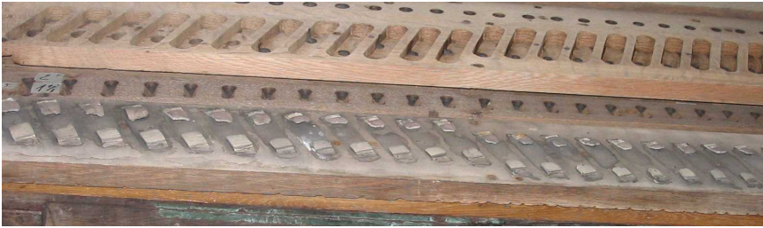
Abb. 1: Repräsentativer Transmissionsstock (Nr. 6). Unten die untere Hälfte des Stockes mit den Rückschlagventilen aus Leder; oben die umgedrehte obere Hälfte des Stockes mit den Transmissionskammern [zwischen den Stockhälften ist Stock Nr. 5 sichtbar] (Foto: Martin Schulze).
